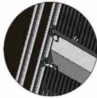
FASE -2- ASCENSO PEINANDO LA REJA -2- PHASE COMBING THE RACK ASCENT
