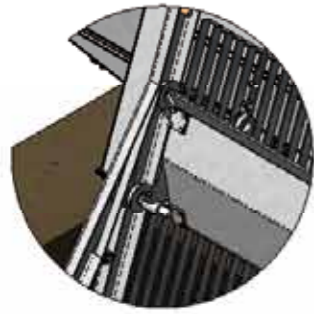
FASE -3- ASCENSO BAJO GUIA DE DESVIO -3- PHASE UNDER THE DESVIATION GUIDE ASCENT
